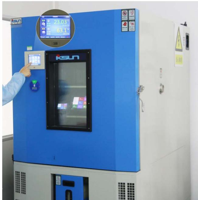
图 3-3 高低温老化测试图
